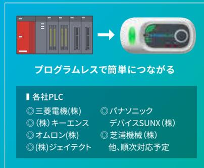
ゲートウェイがPLCのデバイス値をプログラムレスで読み出すので、プログラムの追加や変更は不要。また、RS-485タイプはModbus (RTU) に対応。インバータ等を31台まで接続可能です。
