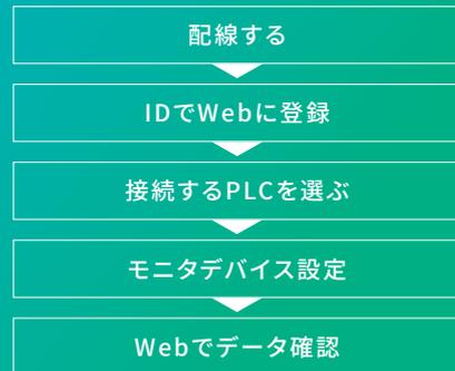
設定画面上でPLC機種やデータ収集するデバイスを選択するだけ。プログラムは不要で、クラウドやデータベースの専門知識がなくても遠隔監視をスタートできます。
