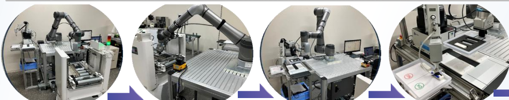
①製品を運ぶ ②モバイルから受取 ③次工程へ ④トレイへ移す
