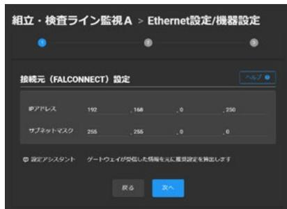
ネットワークやセキュリティなどの専門知識は不要です。接続先機器のIPアドレスを設定するだけで、遠隔地のFA機器とセキュアな接続を実現できます。
