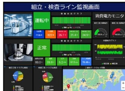
装置に合わせて任意のダッシュボード画面を作成可能。ウィジェットを選択して配置するだけの手順で作成できるので、複数のゲートウェイで収集したデータを簡単に見える化できます。
