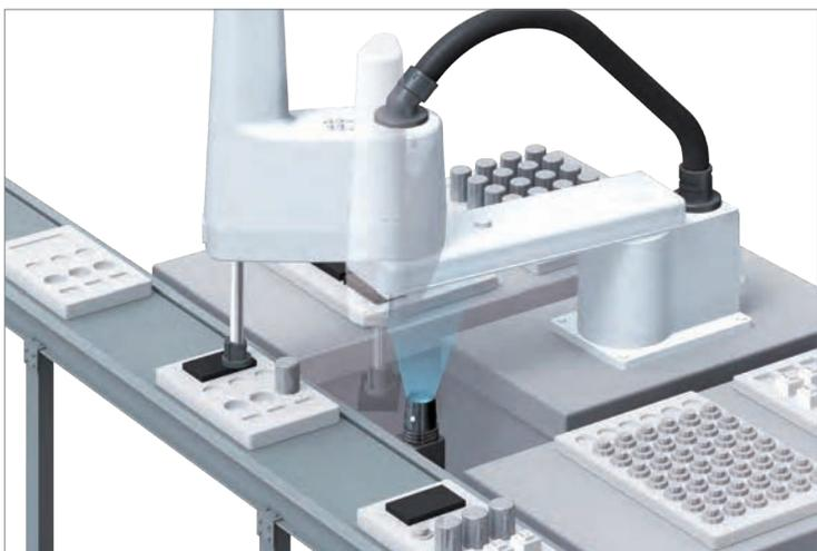
水平方向でのネジ締め
