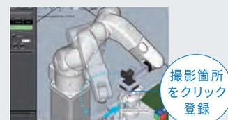
ロボットのオフセット TCP を目標位置へクリックするだけで簡単位置登録できます。
